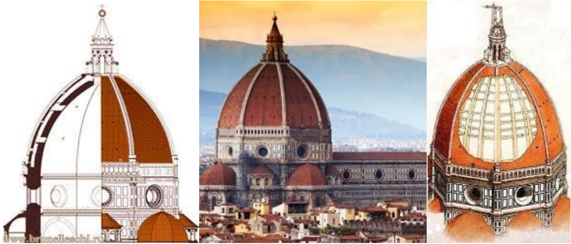
Рис.7. Купол з двох оболонок, пов'язаних 24 ребрами та 6 горизонтальними кільцями
