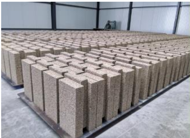
Рис. 1.Блоки виготовлені з конопель
