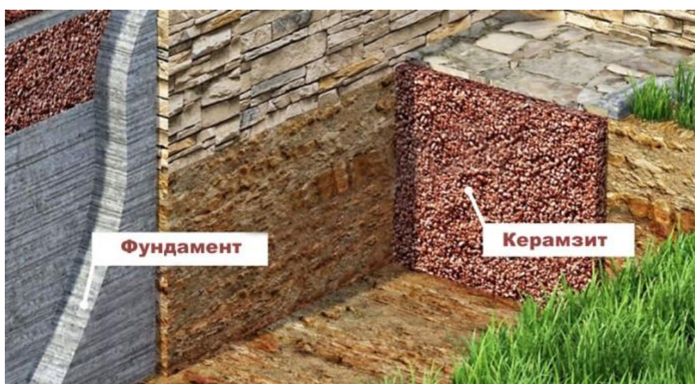
Рисунок 1 - Утеплення фундаменту керамзитом
