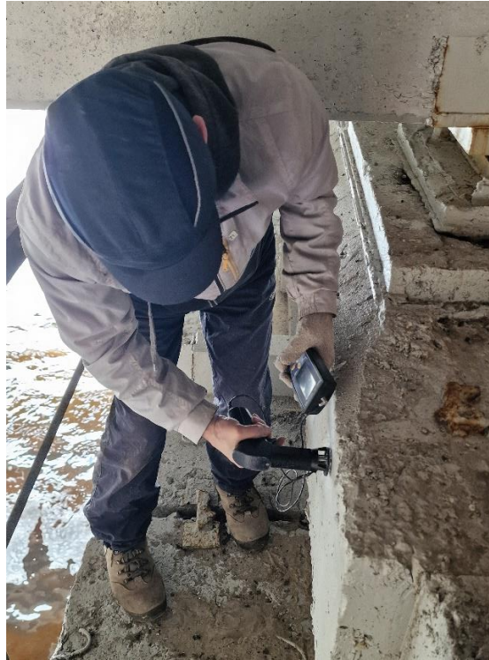
Рисунок 5 – Визначення міцності ригеля гідротехнічної споруди
