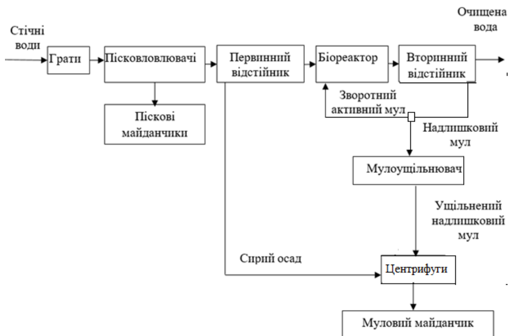
Рисунок 1 – Технологічна схема очистки та обробки осадів стічних вод
