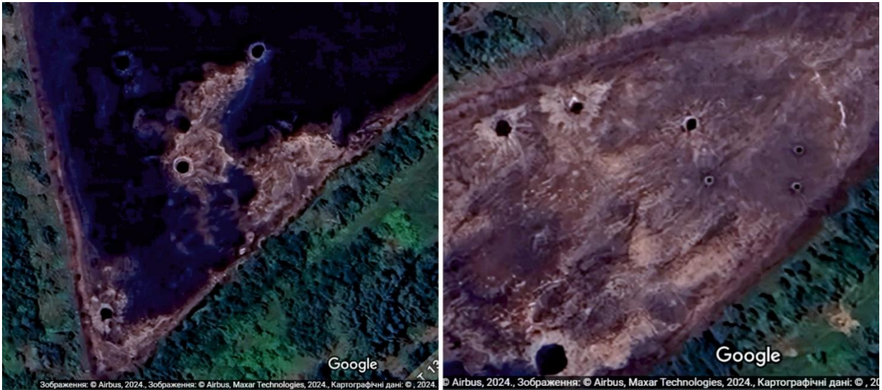
Рисунок 3 - Сліди влучань снарядів в секціях накопичувача (зображення взято із Google, 2024)
