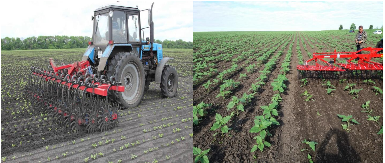
Рис. 4.5 Контроль забур'яненості посіву соняшника декоративного за допомогою ротаційної мотики та штригельної борони
