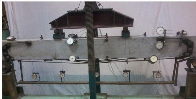
Рис. 2. Загальний вигляд балки з запропонованою регульованою конструкцією підсилення під час випробування
