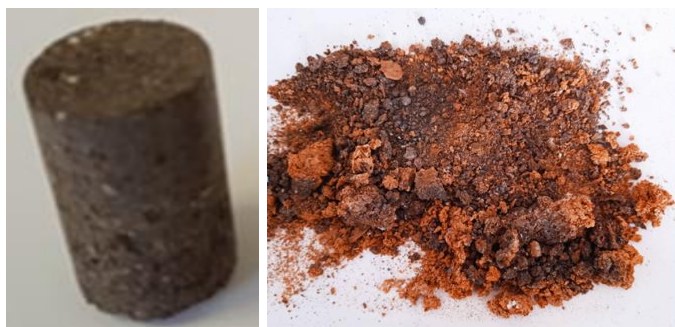
Рис. 1. Вигляд гранули ( d = 16 мм, h = 30 мм), виготовленої з осаду стічних вод та її зольного залишку після згорання
