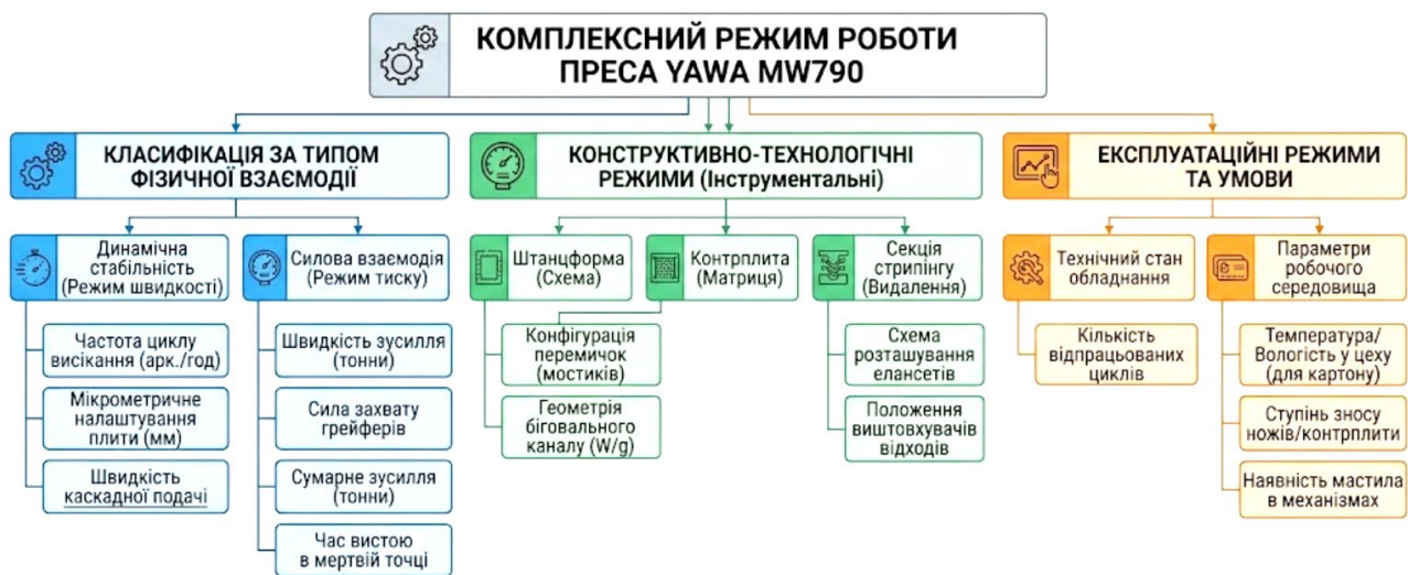
Рисунок 1 – Взаємозв'язок технологічних режимів виготовлення пакувальної продукції
