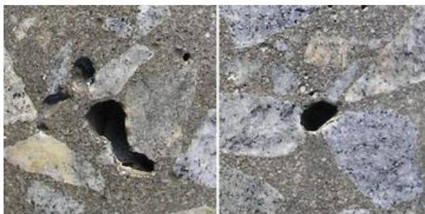
Рисунок 1. Пори у структурі бетону з K_{36}=0,7
