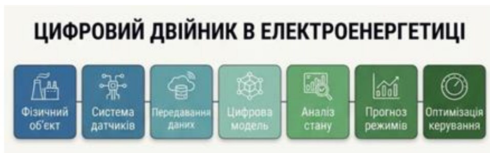
Рис. 2. Структура цифрового двійника в енергетиці.
