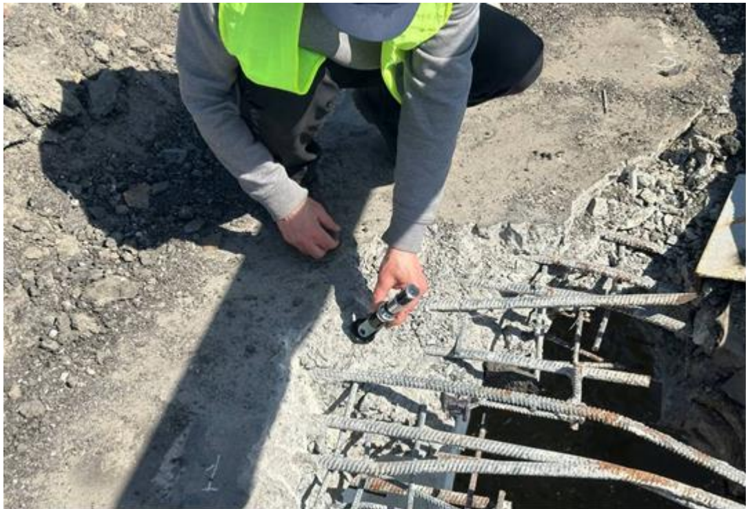
Рис. 5. Уточнене визначення ширини розкриття тріщин за допомогою мікроскопу МПБ-2.
