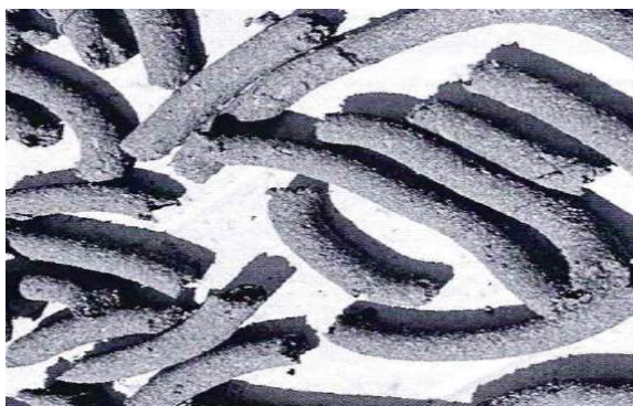
Рисунок 2 – Загальний вигляд біопаливних пелет діаметром 16 мм, виготовлених на модернізованому шнековому пресі з композитної сировини на основі мулових осадів
