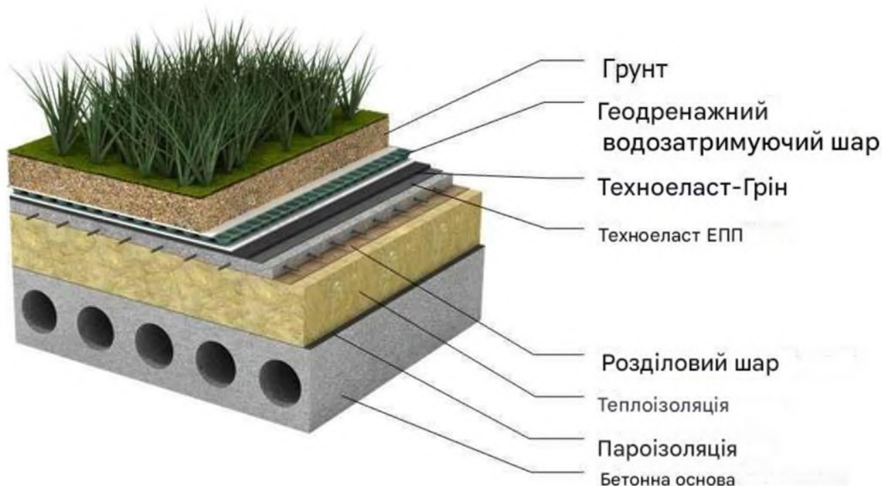
Рис. 1. Схематичне зображення конструктивних шарів зеленої покрівлі (джерело: адаптовано з технічних матеріалів компанії TechnoNICOL)
