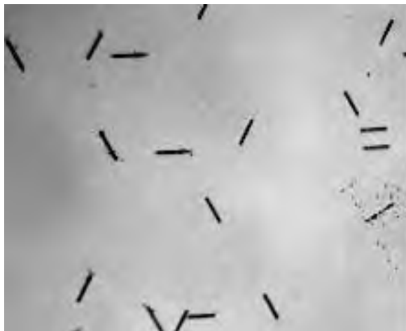
Рис.1. Поверхня діодної структури з виявленими ОДУ
