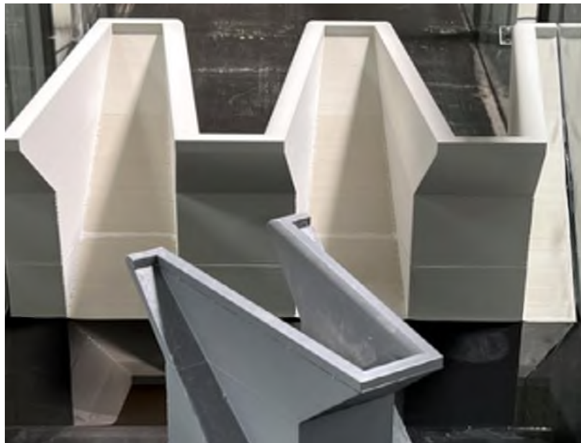
Рис. 3. Технологічні дослідження та інновації – 3D-друковані фізичні моделі нелінійних дамб
