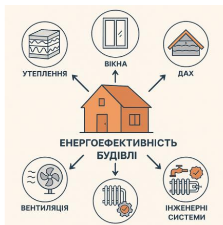
Рис. 1. Елементи, що впливають на енергоефективність будівлі: утеплення, вікна, дах, вентиляція, інженерні системи та розподіл тепловтрат
