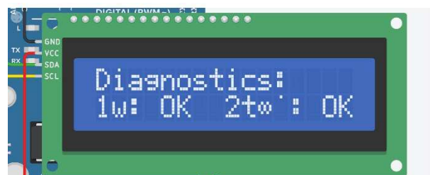
Рисунок 6 – Тест датчиків (датчики ваги та температури на зв'язку)
