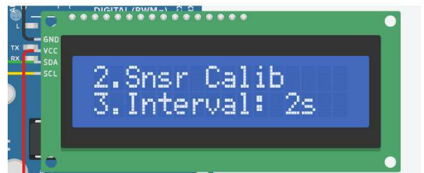
Рисунок 4 – Додаткові режими налаштувань (калібрування датчиків, інтервал оновлень)
