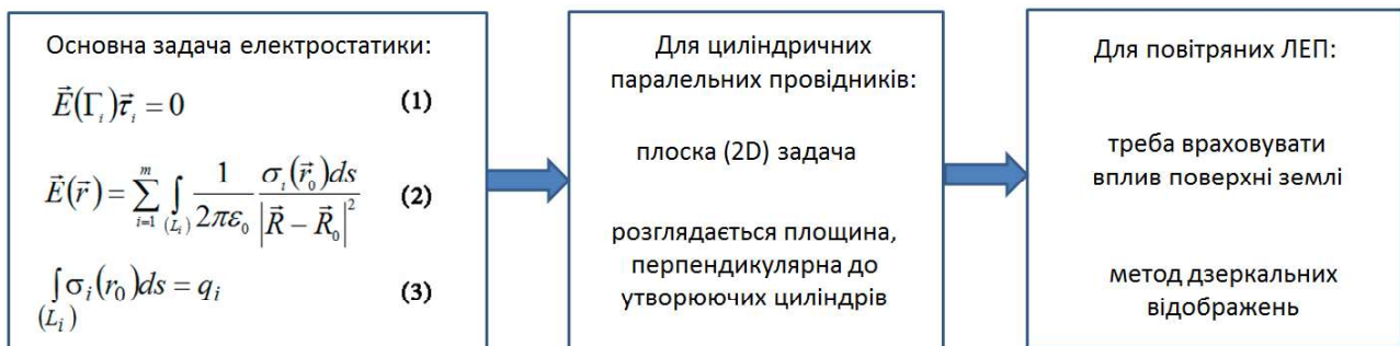
Рисунок 1 – Можливість застосування основної задачі електростатики до розрахунку повітряних ЛЕП ( E(\Gamma_i) - значення напруженості електричного поля на поверхні \Gamma_i , що створюється усіма зарядами системи, \tau_i - вектор, напрямлений за дотичною до поверхні i -го провідника, m – кількість провідників, s – площа поверхні i -го провідника, L_i – довжина i -го контуру, R_0 – радіус-вектор, що визначає положення заряду, \sigma_i – поверхнева щільність заряду, q_i – заряд i -го провідника)
