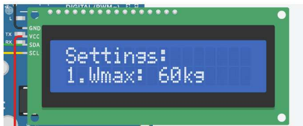
Рисунок 3 – Режим налаштувань (максимально допустима маса)
