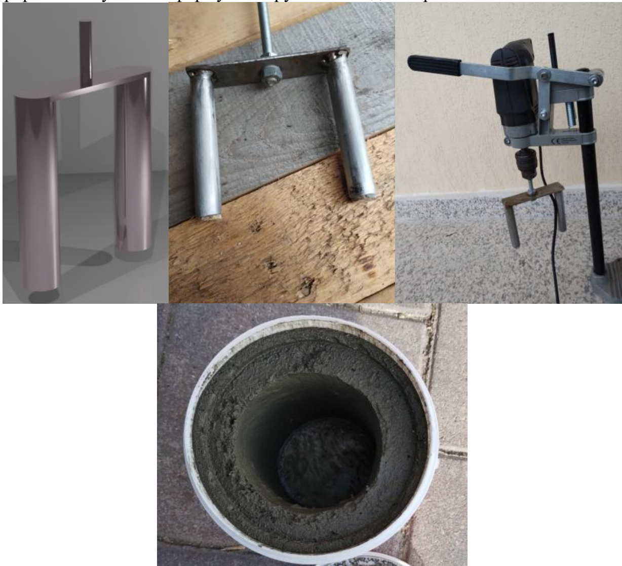
Рис. 3. Запропоноване обладнання для формування виробу та зразок після формування
