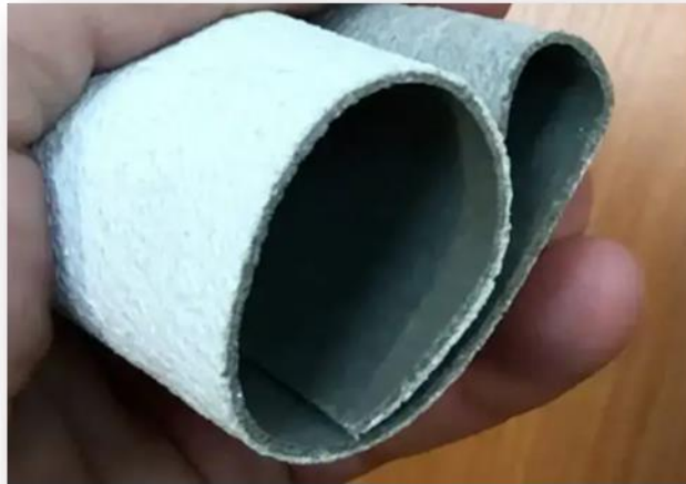
Рис. 2. Зразок шару еластичної гідроізоляції на цементно-полімерній основі
