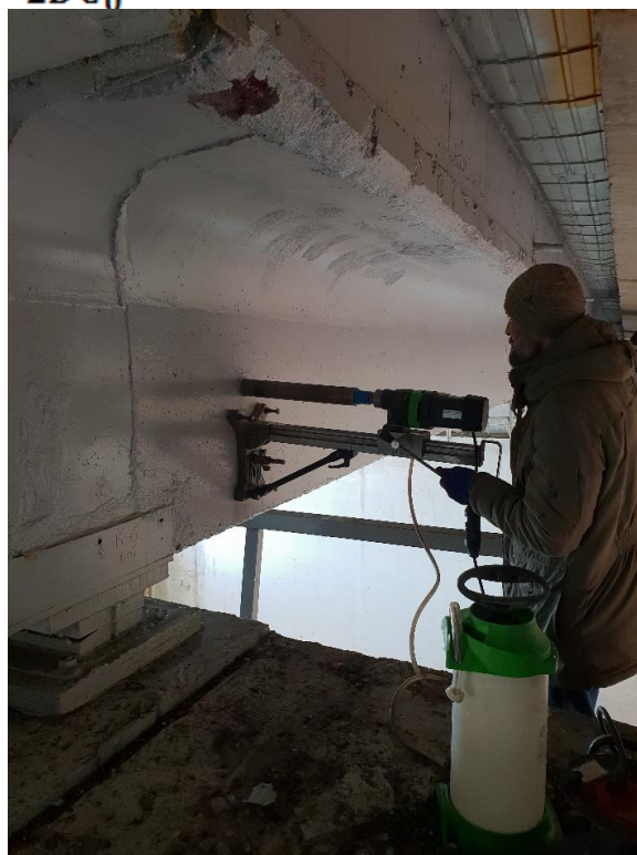
Рис. 2. Відбір кернів з тіла балки прогонової будови
