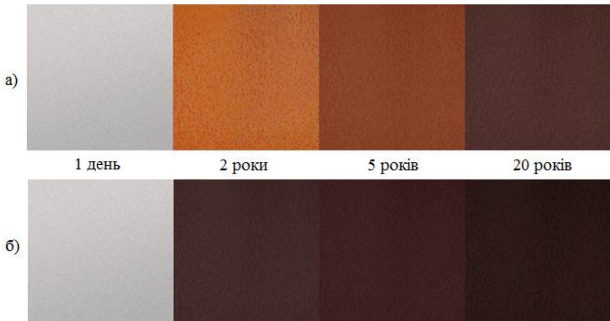
Рис. 3. Зміни кольору оксидного шару на сталі Cor-Ten у часі в сільськогосподарському (а) та промисловому (б) середовищі
