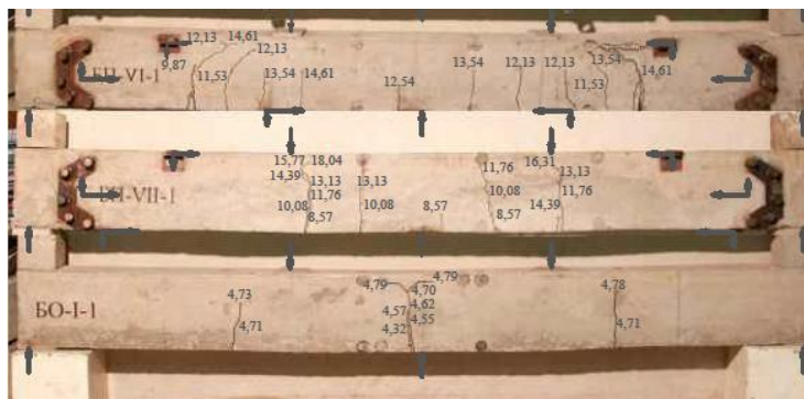
Рис. 6. Характерне тріщиноутворення та руйнування експериментальних балок
