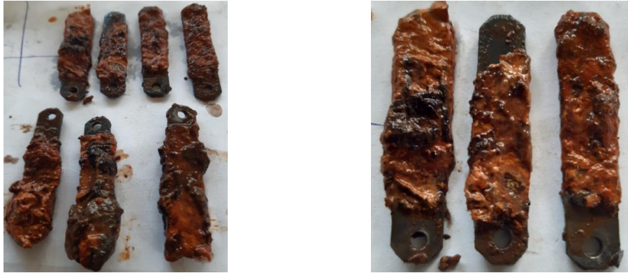
Рис. 3. Зовнішній вигляд зразків після витримки в напірному трубопроводі НС- 2.
