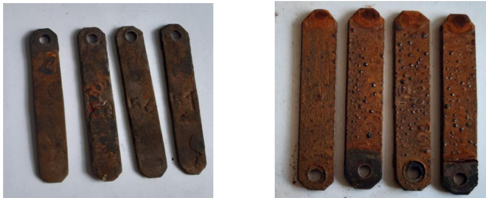
Рис. 3. Зовнішній вигляд зразків після витримки в напірному трубопроводі НС- 2.
