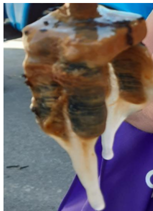
Рис. 5. Загальний вигляд зразків після витримки в суміші підземної і річкової вод
