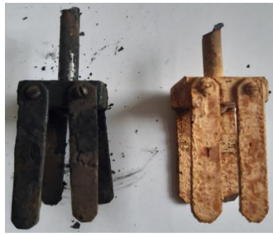
Рис.1. Зовнішній вигляд зразків після витримки у підземній воді свердловин
