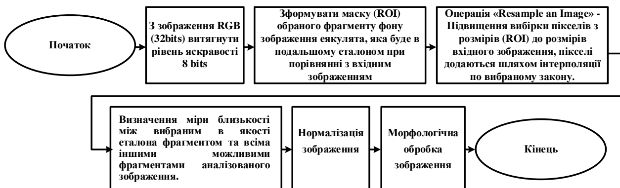
Рис. 1 – Алгоритм визначення міри близькості між фоном зображення еякуляту і вхідним зображенням сперми пацієнта
