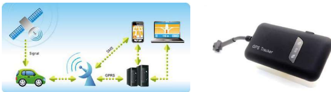
Рис. 3 – GPS-трекер: схема дії та зовнішній вигляд
