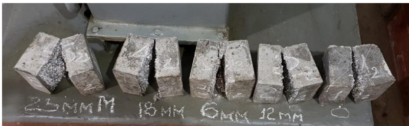
Рис. 3. Загальний вигляд зразків після випробування на розтяг при розколюванні
