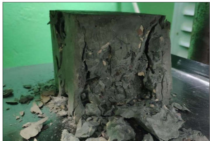
Рис. 2 Загальний вигляд бетонного зразка з додавання битої керамічної плитки фракції 5 мм: а - до випробування; б- після випробування
