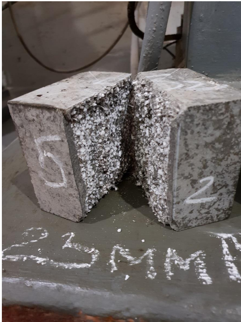
Рис. 4. Пінополістерол в перерізі розколу зразка бетону після випробування на розтяг .
