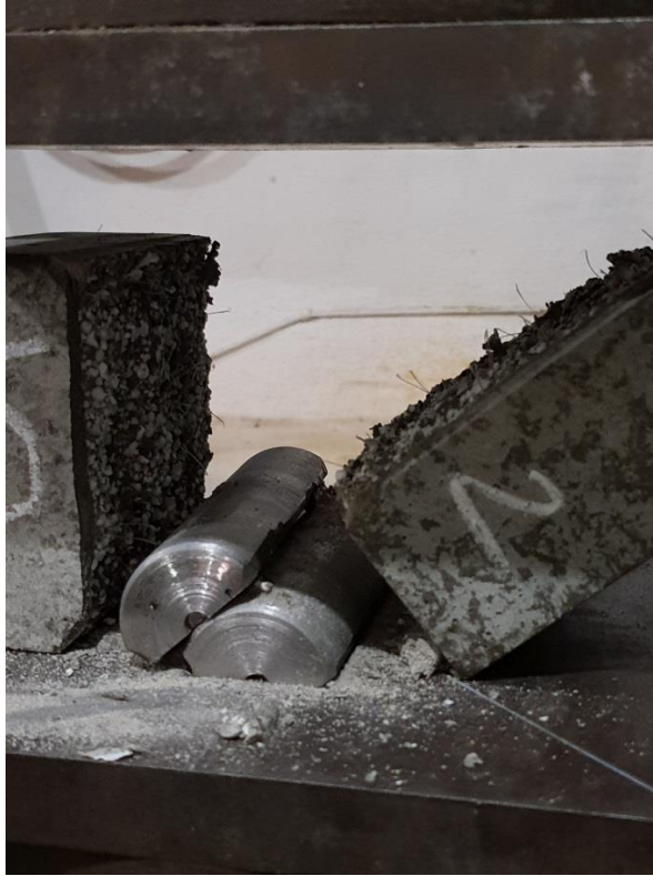
Рис. 2. Структура розколу в перерізі зразка куба з фіброю №5
