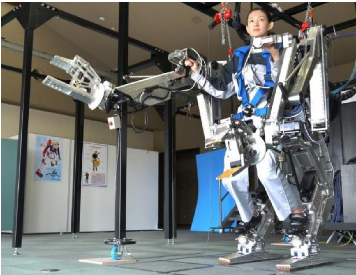
Рис. 1. - Приклад будівельного екзоскелету
