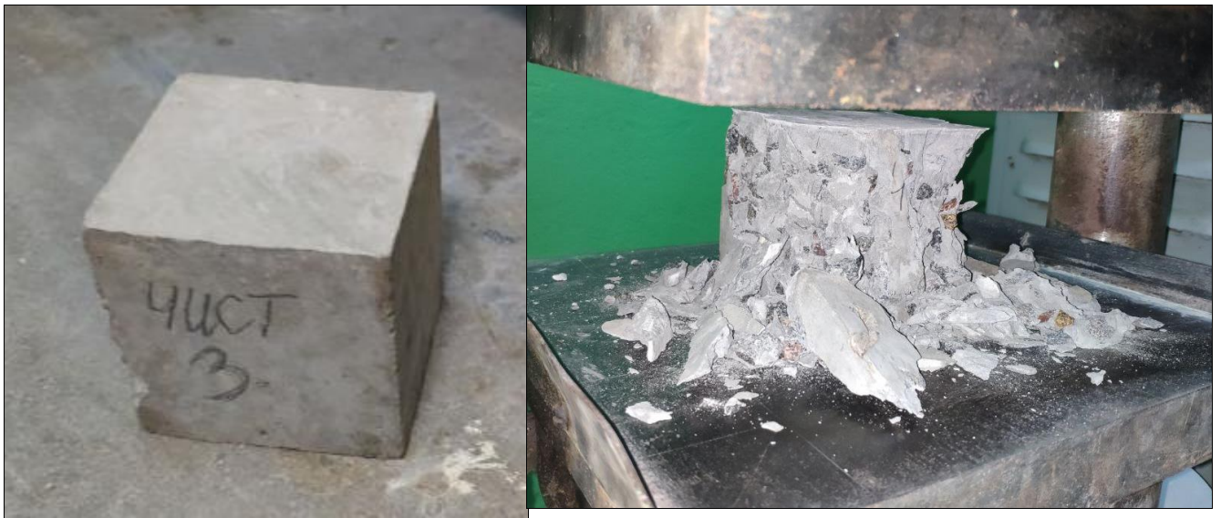
Рис. 1 Загальний вигляд бетонного зразка без додавання додаткового заповнювача: а - до випробування; б- після випробування
