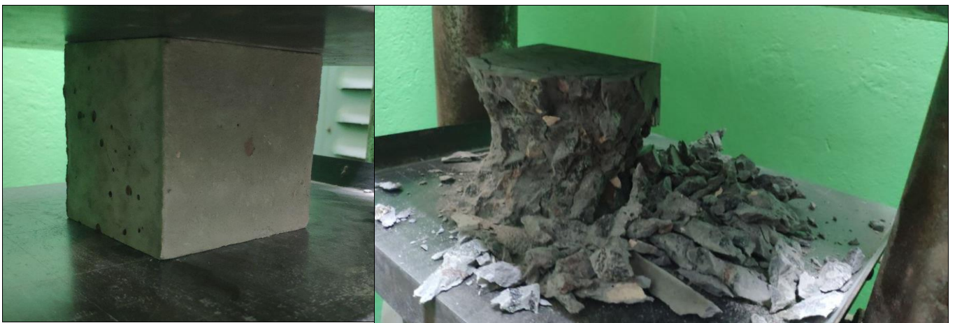
Рис. 2 Загальний вигляд бетонного зразка з додавання битої керамічної плитки фракції 5 мм: а - до випробування; б- після випробування
