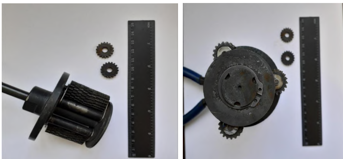
Рисунок 2. Універсальне свердло для механічної «сухої» дезактивації
