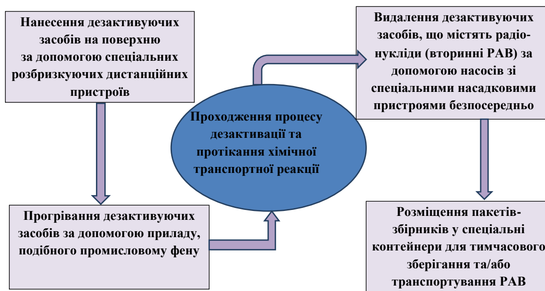
Рисунок 3. Технологічний процес дезактивації поверхнево забруднених матеріалів
