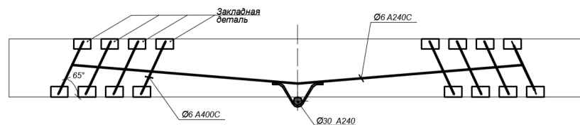
Рис. 1. Схема підсилення балки БПІ-П-1 поздовжньою і поперечною паралельно розташованою зовнішньою арматурою
