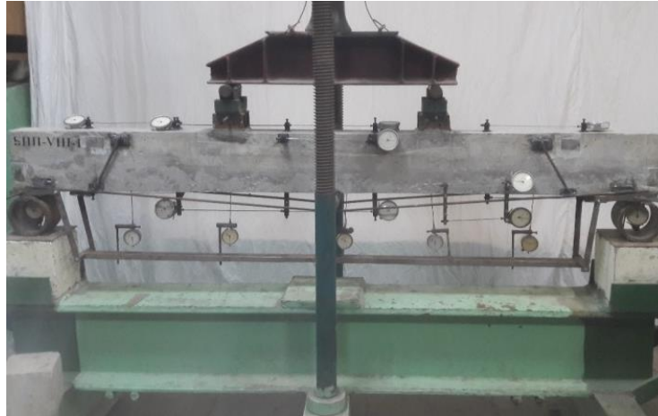
Рис. 3. Випробування балки зі вставкою,затяжкою і розтяжками
