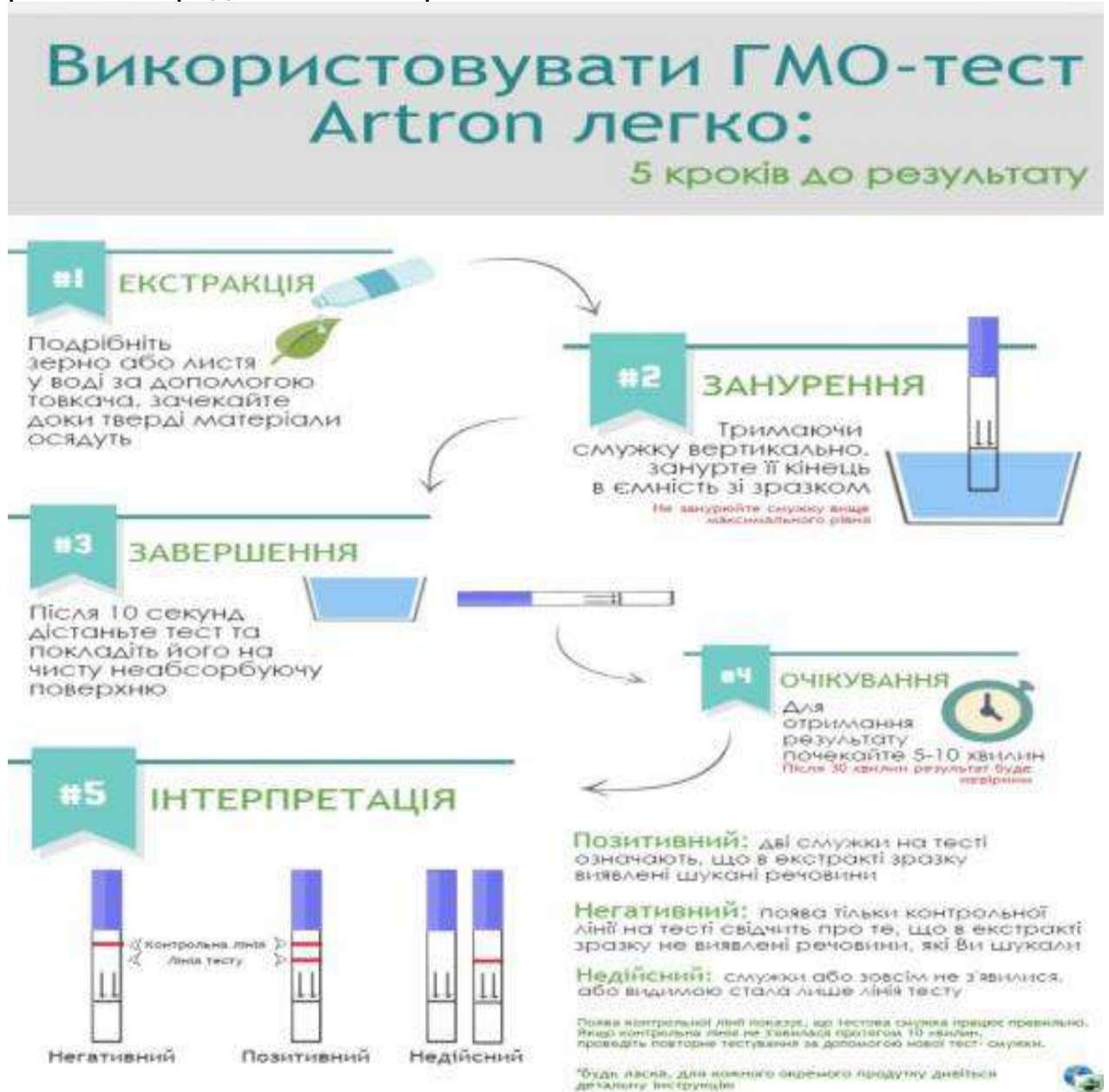
Рис. 1. Схема проведення лабораторного аналізу на вміст ГМО в рослинах
