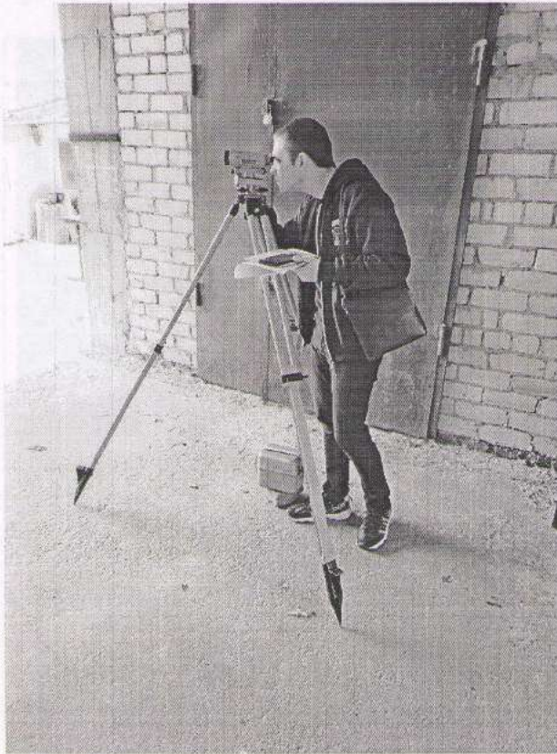
Рисунок 1 – Налаштування в робоче положення нівеліра Н-3 бригадою здобувачів 3 курсу спеціальності 103 «Науки про Землю» і пояснення особливостей нівелювання навчального корпусу факультету ВГБЗ
