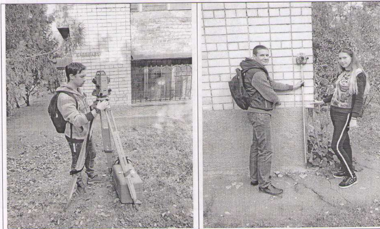
Рисунок 2 – Визначення відхилення стіни гуртожитку №6 від вертикалі за допомогою електронного тахеометра SOKKIA SET-630RK та відбивача і лінійки (здобувачі 4 курсу)
