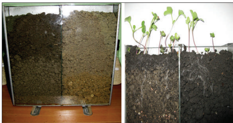
Рис. 1. Загальний вигляд пристрою ПРКС (зліва) та пророщування насіння редьки олійної у ньому (вигляд справа)
