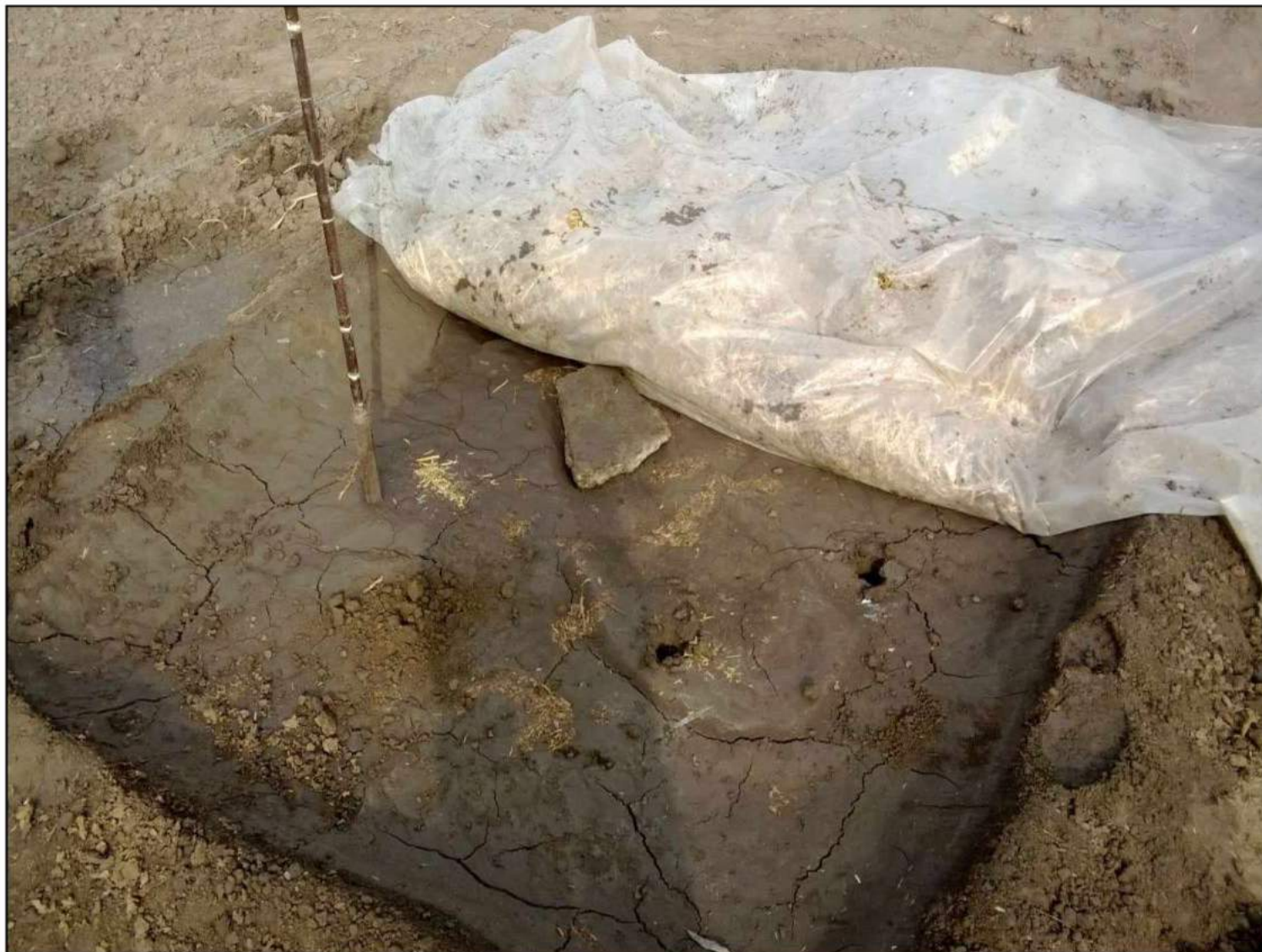
д). пошарове (через 10 см) визначення вологості ґрунту у 4 разовій повторності та одночасне знімання показів тензіометрів
