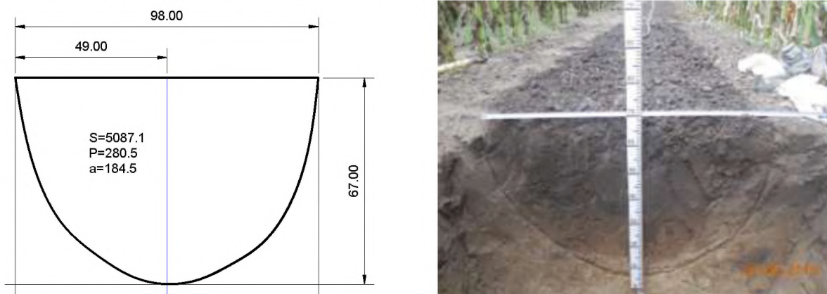
Рис. 14. Фактичний контур зони зволоження легкосуглинкового ґрунту, варіант 3,6 \text{ м}^3/100 \text{ м} ряду (ДП «ДГ «Брилівське» ІВПіМ)
